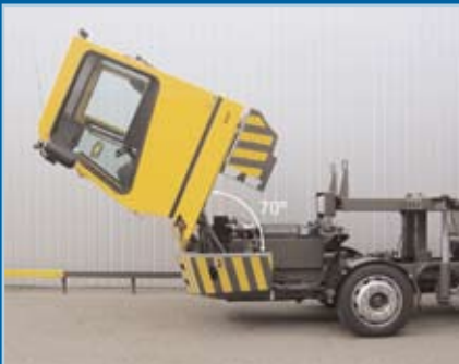
Optimaler Zugang zum Motor durch kippbare Kabine
